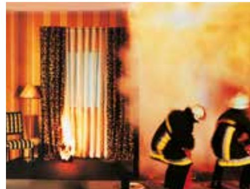
Ensaio comparativo de inflamabilidade: este ensaio revela como os têxteis Trevira CS de baixa inflamabilidade (esquerda), após extinção da fonte de ignição, apenas derretem lentamente, enquanto os têxteis convencionais (direita) ardem completamente em chamas.
