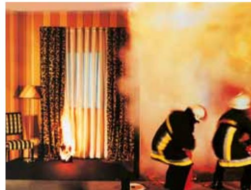
Test comparativo di incendio: il test mostra la lentezza di propagazione della fiamma sui tessuti ignifughi Trevira CS (sinistra) dopo l'estinzione della fonte d'innesco, rispetto ai tessuti tradizionali (destra) che si infiammano velocemente.
