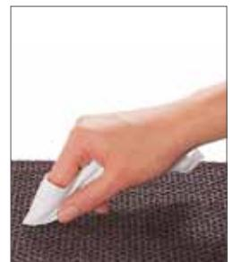
Solidité élevée au frottement humide: Trevira CS ne laisse aucune trace sur un chiffon blanc humide, même si le tissu est frotté vigoureusement avec celui-ci.
