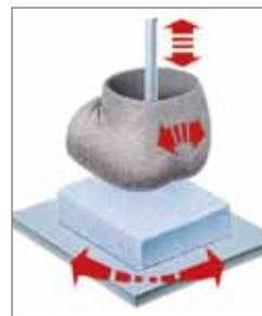
Ce test simule la sollicitation classique des sièges rembourrés. Trevira CS démontre ainsi une grande résistance à l'abrasion et au frottement.
