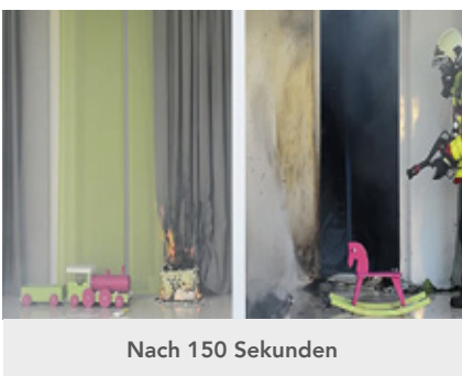
Vergleichender Brandversuch: Dieser Test zeigt, wie schwer ent-flammbare Trevira CS Textilien (links) nach Erlöschen der Zündquelle nur langsam einschmelzen, während her-kömmliche Textilien (rechts) komplett in Flammen aufgehen.
