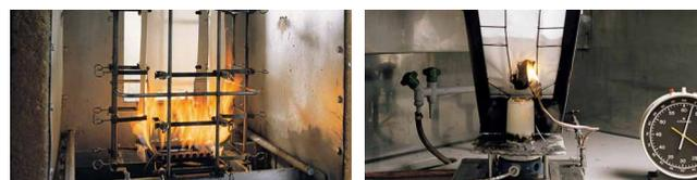
In den wichtigen internationalen Brandprüfungen gilt Trevira CS Bioactive als schwer entflammbar. Hier der strenge Test nach DIN 4102, Klasse B1, sowie einer der weltweit härtesten Brenntests für Frankreich mit dem „Brûleur électrique“.
