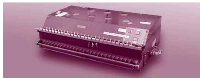
Avec l'appareil KST, les fibres sont soumises à un essai de pliage et d'abrasion
