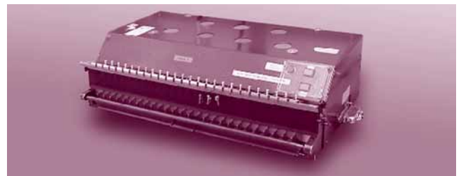
Mit dem KST-Gerät wird an Fasern eine Knickscheuerprüfung durchgeführt.
