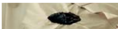
Trevira CS Sicherheitsstoffe bewirken, dass eine Flamme – verursacht beispielsweise durch brennendes Zeitungspapier – selbsttätig erlischt.
